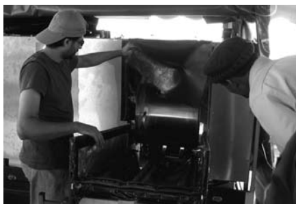
Eine eigens entwickelte Spülmaschine für große Töpfe.
