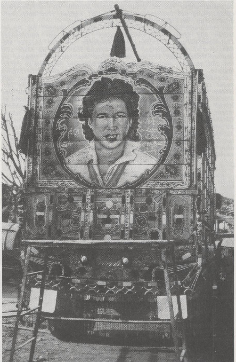
lungen ein breiter, offener Platz. Hier befindet sich eine Art Gewerbegebiet für Lastwagen, in denen jeder nötige Service geboten wird. Neue Lastwagen werden hier zusammengebaut und alte wieder aufgemöbelt. Neue Lastwagen verlassen die Fabrik nur sehr unvollständig: als Chassis mit Motor, Lenksäule und Fahrersitz. Alles andere wird nach den Wünschen des Besitzers von kleinen Werkstätten hinzugefügt.
