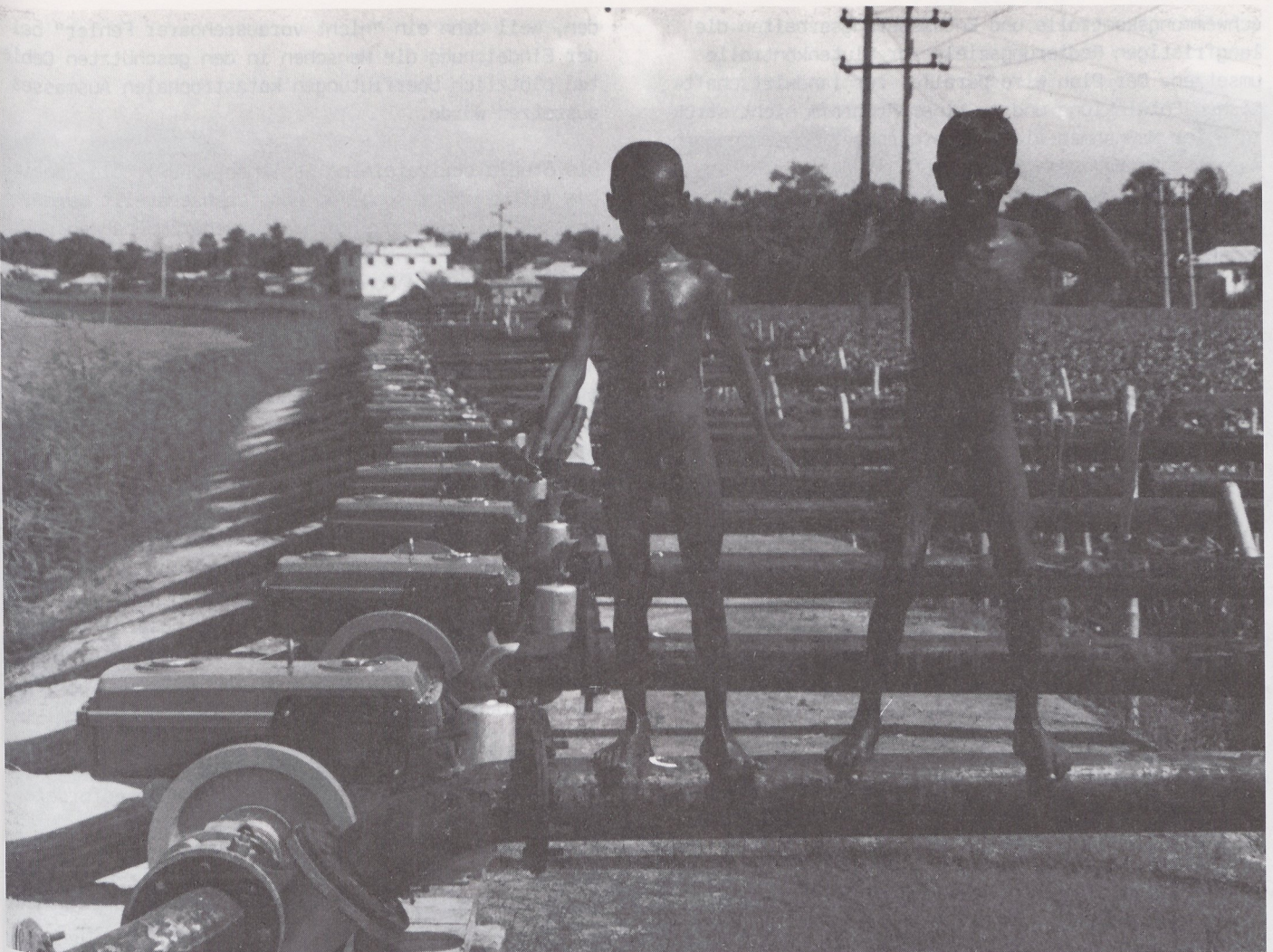
Mit Pumpenanlagen werden überflutete Gebiete entwässert (Foto: Walter Keller)
