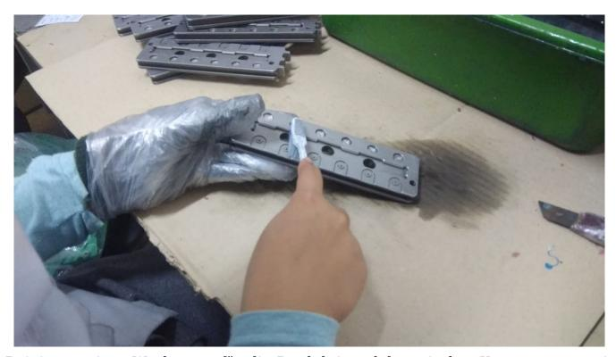
Reinigung eines Werkzeugs für die Produktion elektronischer Komponenten mit chemischen Mitteln mit starkem Geruch und gesundheitsschädigender Ausdünstung © LIPS
